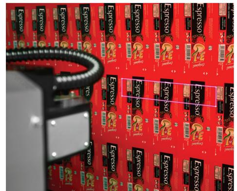
SLC 350HD+ se suministra con un diodo guía, que agiliza los ajustes y reduce el tiempo de cambio y los residuos
