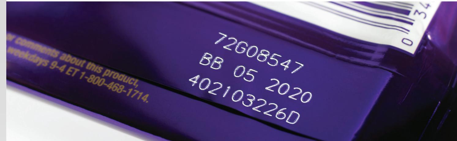
Los láseres pueden ser útiles en muchos escenarios. Pueden codificar en áreas pequeñas de cajas entintadas o a través de múltiples carriles de película flexible de banda ancha donde no pueden llegar otros métodos, y pueden ayudarle a codificar efectivamente sobre vidrio o metal.
